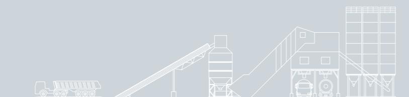
Durch ausgewogene Lastenverteilung können die umsetzbaren Kaiser Beton-Misanlagen an unterschiedlichen Standorten errichtet werden, modulare Baugruppen erlauben eine optimale Anpassung an die Platzverhältnisse. Rundsilo und Reihenbunker, verschiedene Förder- und Beschickungs-Techniken sowie mehrere Mischervarianten sind verfügbar, weiters Vor- und Nachsilo für eine Hochleistungsanlage.
